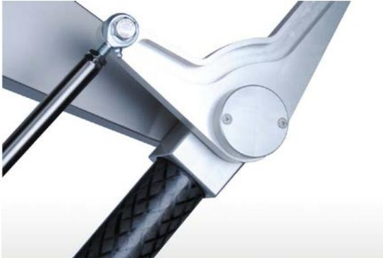
**Bild 3:** Codian Robotics setzt beim Bau der Delta-Roboter auf moderne Leichtbau-Werkstoffe wie Kohlefaser, Titan, eloxiertes Aluminium, 316 Edelstahl und Kunststoff.
